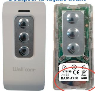
**Retirer la pile de son logement puis la remplacer en respectant la polarité indiquée. Reclipser la façade**
